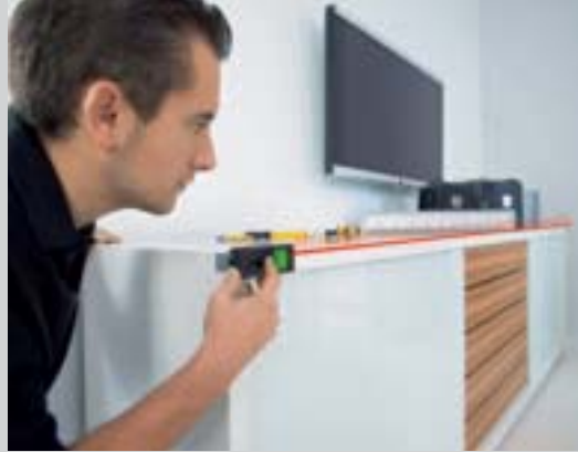
Mesures à partir d'arêtes ou de coins – grâce à la pièce finale rabattable, vous êtes équipé pour chaque type de relevé.
